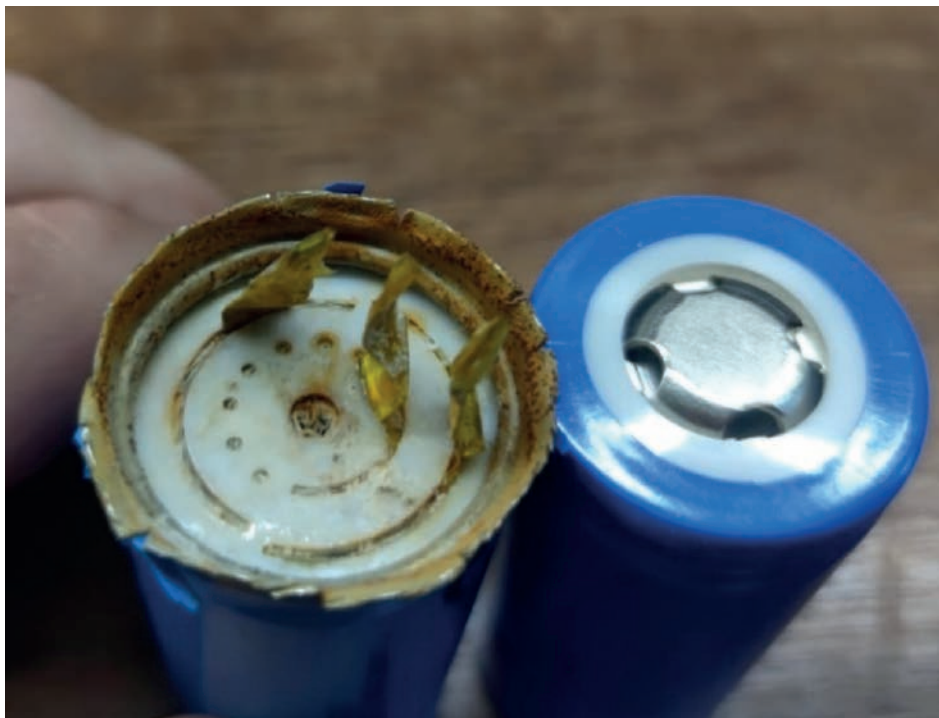
Na fotografii vidíte 3,2V článek přebíjený 6-ti V. Po 10-ti minutách došlo k zahřátí na 160°C a přerušení.
